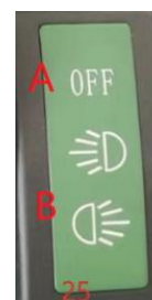
Fig. : 45 Interruptor de las luces delanteras y traseras de la cabina.
