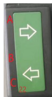
Fig. : 43 Interruptor de luces delanteras y traseras
