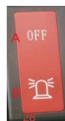
Fig. : 49 Interruptor de la baliza giratoria.
