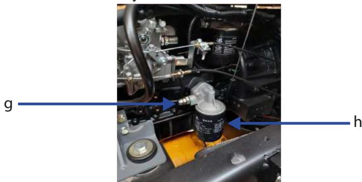
Cambie el aceite del motor, cuando el aceite este caliente después de un tiempo de trabajo, sustituya el filtro (h).
