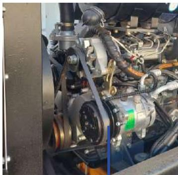
Revisar el estado de la correa del motor, reemplazar si es necesario
