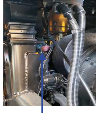
Respiraderos de la caja de transmisión
