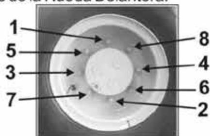
1- Instale las 8 tuercas de montaje de rueda. Ajuste cada una de ellas en la secuencia indicada hasta que la rueda quede firme al cubo del eje.
