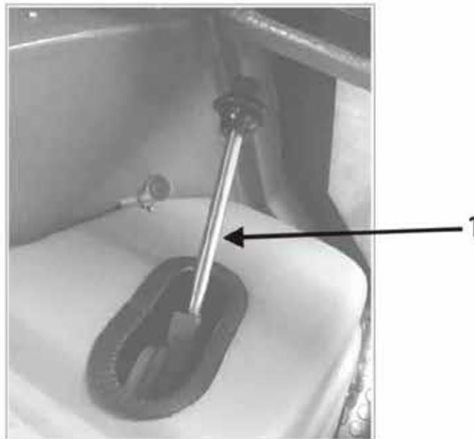
Empuje la palanca en posición, alejándola de usted, para incrementar la velocidad del motor. Luego tire de la misma hacia usted para disminuir la velocidad.
