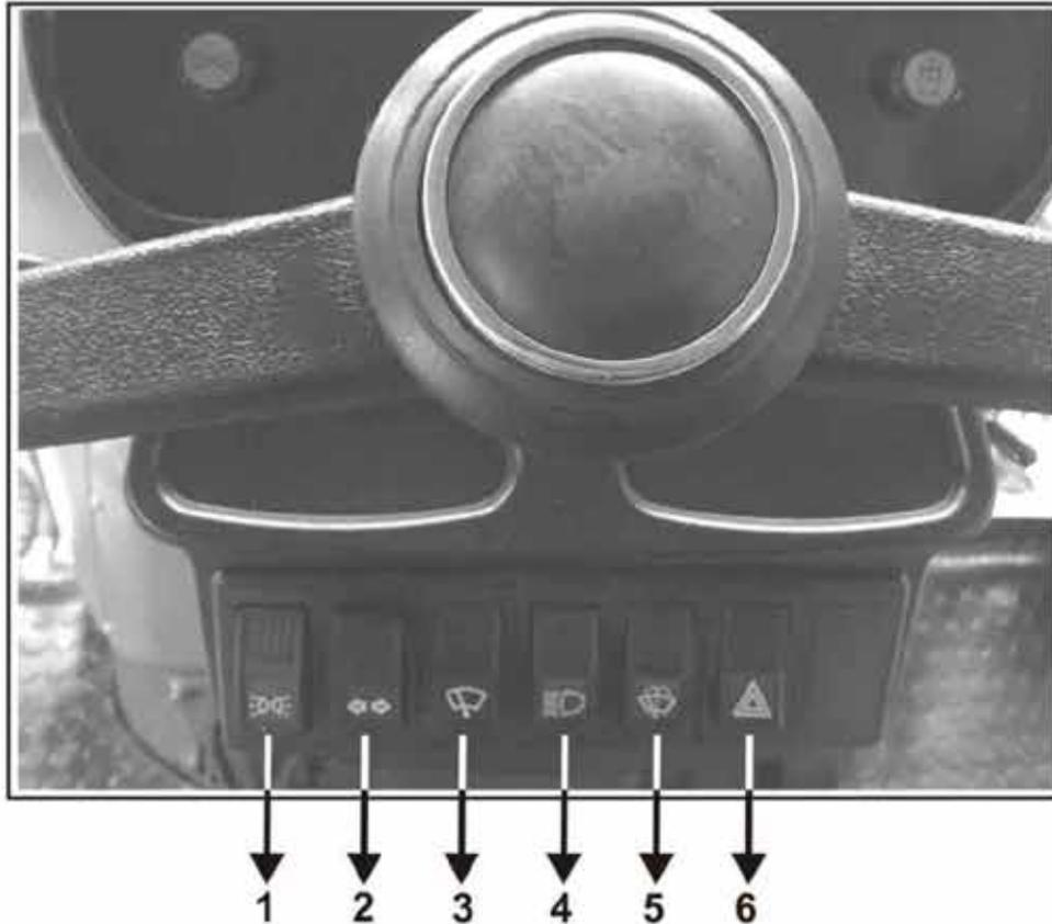
**1- Interruptor de Luces de Obra:** Presione la tecla con el símbolo para encender las luces de obra. Luego presione el extremo opuesto para apagarlas.
