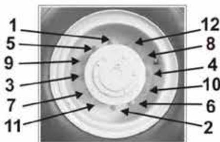
1- Instale los 10 bulones de montaje de rueda. Ajuste las tuercas, en la secuencia indicada, hasta que la rueda tope con el cubo del eje.
