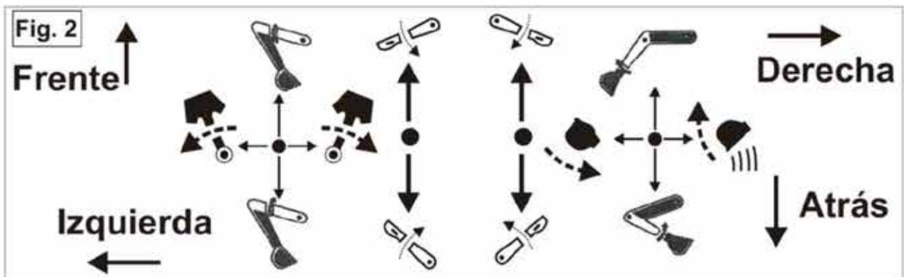
La palanca de control de la pala frontal y retro está en la parte posterior de la máquina. Gire la butaca 180°. Las palancas se controlan de la siguiente manera **ver fig. 2.**
