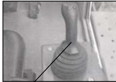
Palanca de maniobra de brazo motriz
