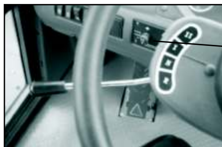
Panel de control de calefacción
