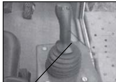
Palanca de maniobra de brazo motriz
