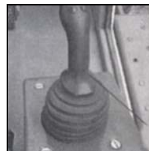
Palanca de maniobra de brazo motriz
