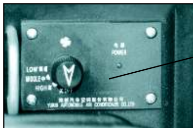
Panel de control de calefacción
