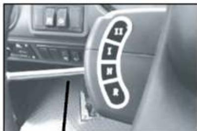
• Poner la palanca de maniobra de cambio de velocidad en posición "Neutra".
