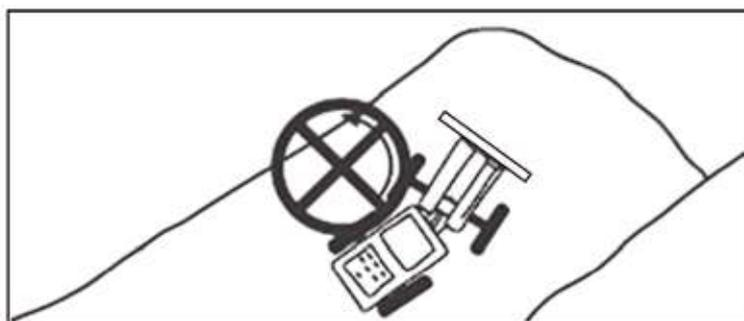
Cuando el transporte se realiza en zona de terreno inclinado, la topadora debe estar a 20 cm. ó 30 cm. del piso. El interruptor de electricidad debe desconectarse.
