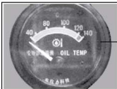
Indicador de temperatura de aceite del convertidor
